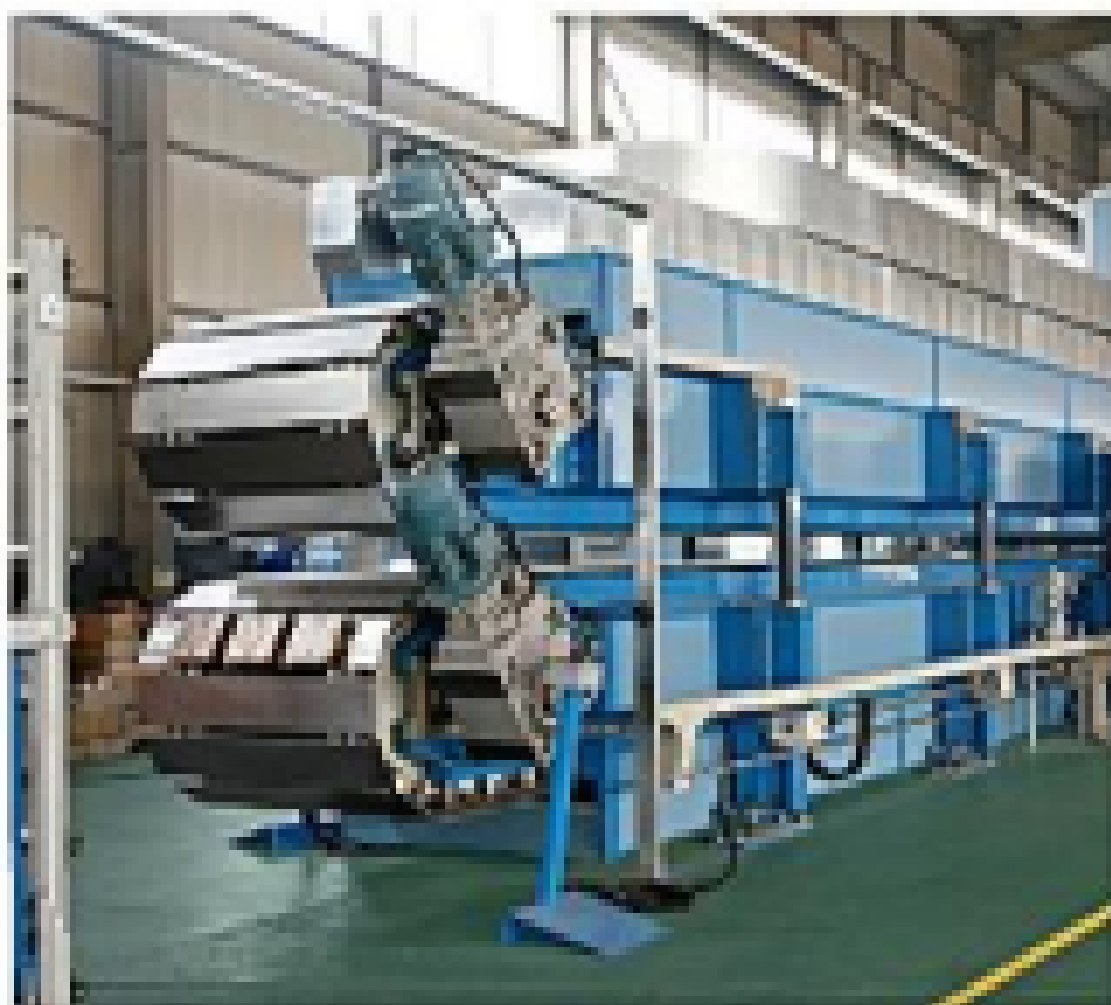
意大利PUMA夹芯板连续生产线, 六组份在线高压发泡, 28m超长双履带成型。
