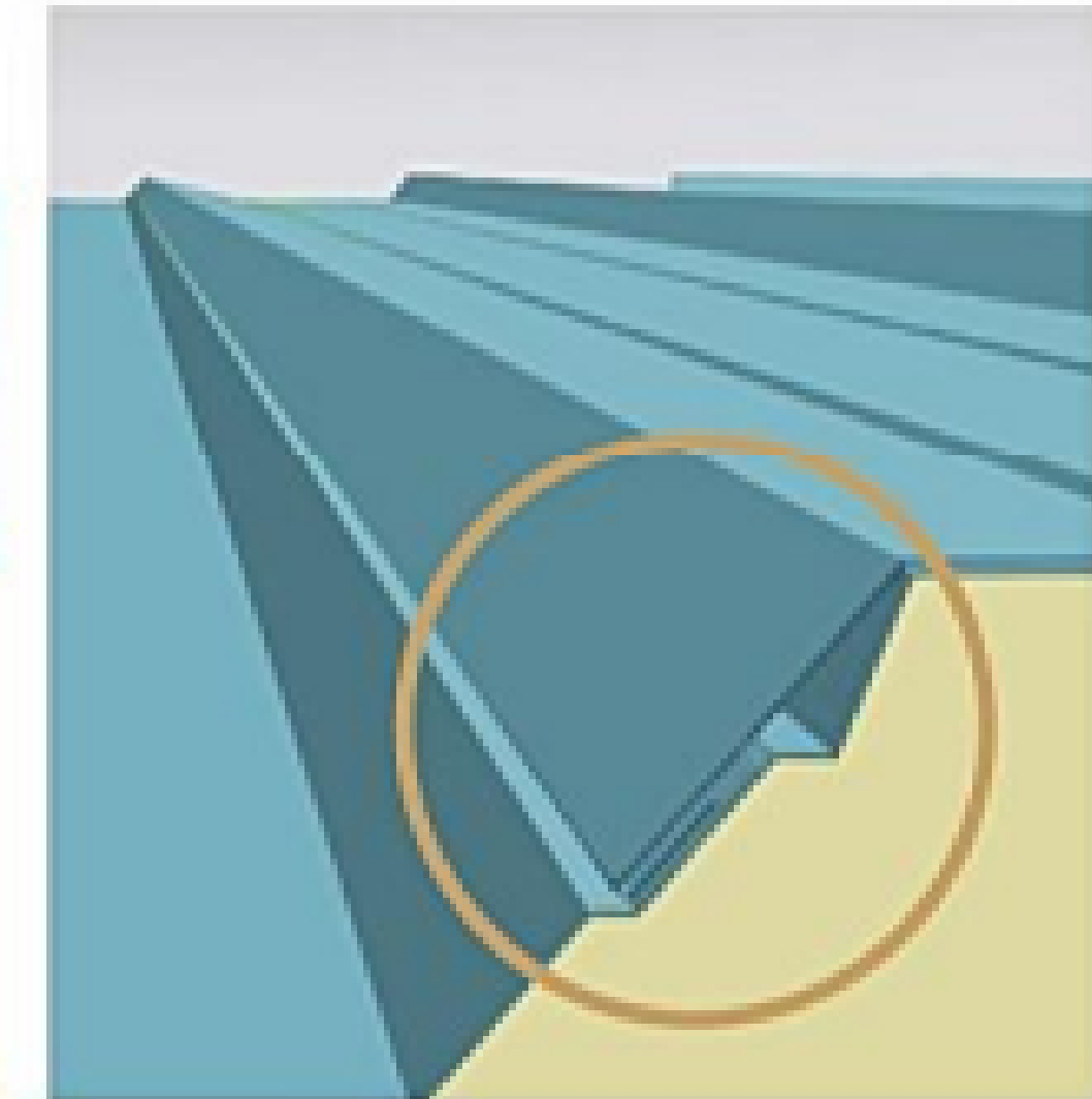
叠边设计, 搭接更紧密, 保护无涂层的端部, 提升屋面寿命
